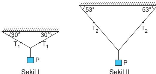
**Buna göre, iplerdeki gerilme kuvvetlerinin büyüklükleri oranı  $\frac{T_1}{T_2}$  kaçtır? ( $\sin 30^\circ = 0,5$ ,  $\cos 37^\circ = 0,6$ )**
