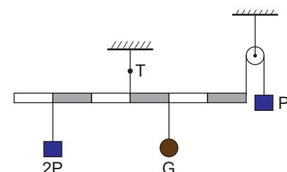
8. 10 N ağırlığındaki eşit bölmeli türdeş çubuk ve 15 N ağırlığındaki cisim gerilme kuvveti  $\vec{T}$  olan iple şekildeki gibi dengededir.
